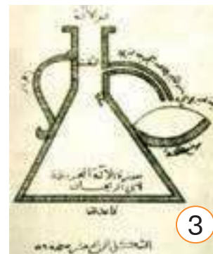
Siqib chiqarilgan suvning hajmini aniqlovchi idish. XI asr
